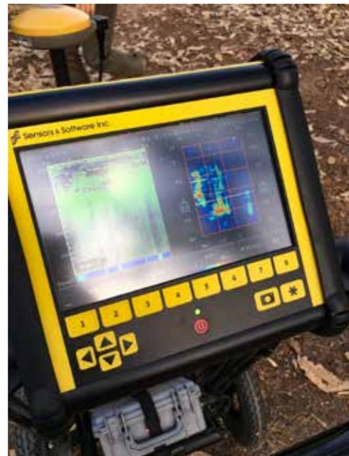
図5：地中レーダー探査機のモニター画面
